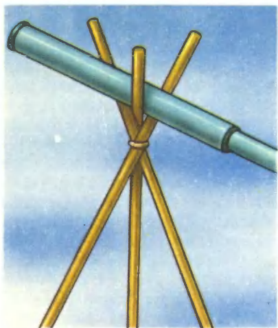
Рис. 84. Простейший штатив для самодельного телескопа.
