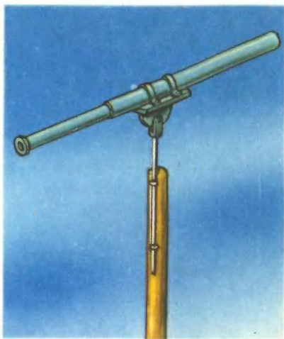
Рис. 85. Неподвижный штатив для телескопа.
